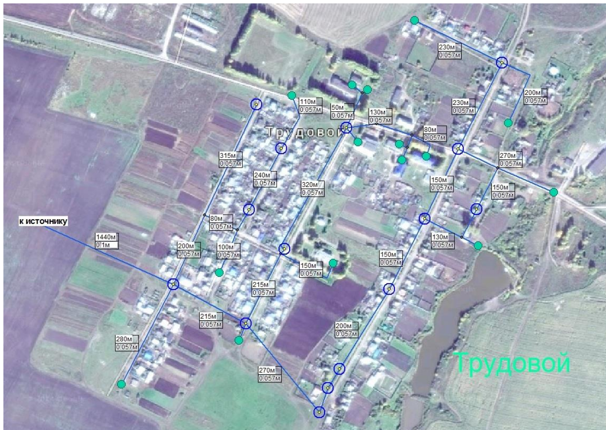
Рисунок 1-3. Зона централизованного водоснабжения п.Трудовой
